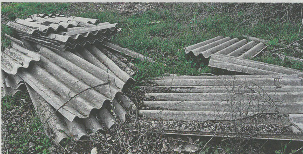
Materiale pericoloso. Le fibre di amianto che si liberano dalla frantumazione dell'Eternit sono causa di mesotelioma
